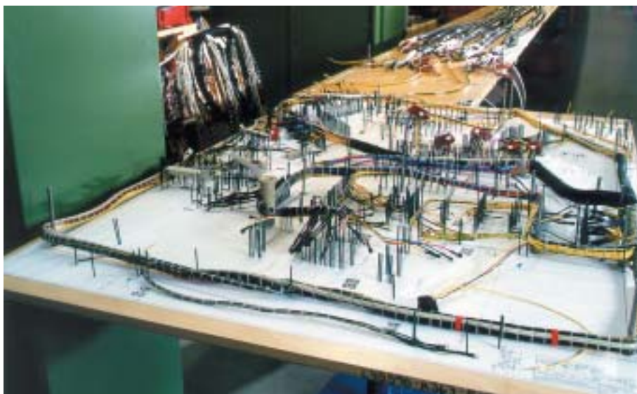
Kabelbaumfertigung - Konfektionierung von Kabeln zu einem kompletten Kabelsystem z.B. für die Medizintechnik
