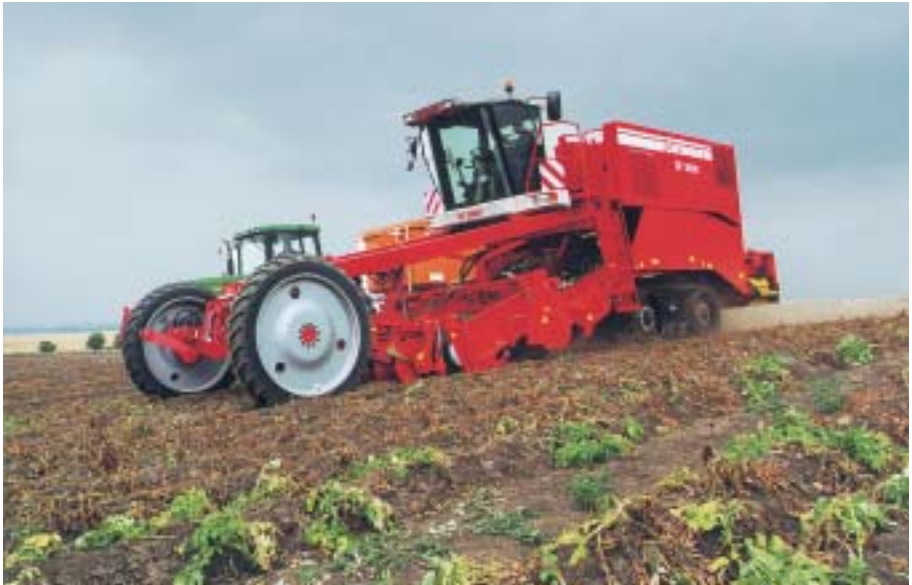
SF 3000: Vierreihige selbstfahrende Überlademaschine mit 326 PS Mercedes-Benz-Motor, mit Raupenfahwerk
